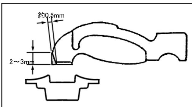
SR20用 Bタイプに使用するリテーナーはSTD品と形状が異なる為、チューニングの仕様によってはロッカーアームとリテーナーが干渉する場合があります。ロッカーアーム先端とリテーナーのクリアランス(1mm程度)が確保できない場合は、左図のようにロッカーアームを切削してください。
