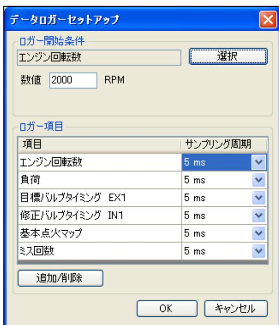
本機はデータロガー機能を内蔵しています。ロガーの操作は、オンライン時に使用することができます。
