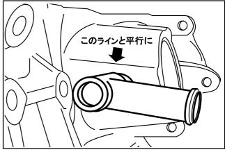
打ち込む際直接ハンマー等でウォーターコネクターを叩くと破損の原因になります。 ※アルミや銅等の柔らかい金属の当て板をあてがって叩き込むとウォーターコネクターの傷や破損を防止します。
