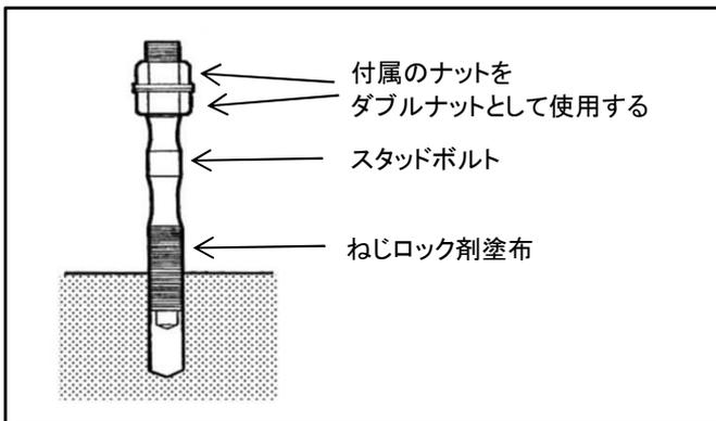
① 付属のナットをダブルナットとしてスタッドボルトの上側ねじ部に固定する。
