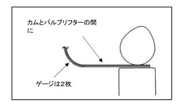
(3) 選定したシムを組み付け再度カムクリアランスを測定し、必要に応じて繰り返し調整を行ってください。
