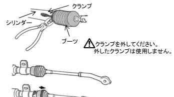
ブーツの内側のつけ根を外し、 ブーツを外側に移動させてください。
