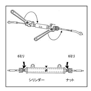
①左右のナットにモンキーレンチをかけ、 両方のナットを6ミリほど緩めてください。
