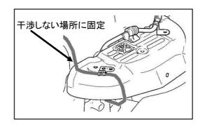
3.TOMEIヒートプロテクターを付属のボルトおよびワッシャーを用いて取り付ける。 【締付トルク 14N·m (1.4kgf-m)】
