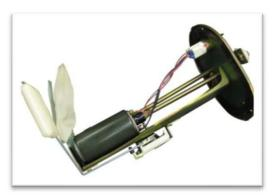
燃料ポンプを燃料タンクから取り出す。 この際、フロートをタンク等に引っ掛けて破損しないように 注意する。
