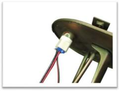
ポンプ本体下部がポンプインシュレーターに確実に収まっていることを確認し、ホースバンドを締めつける。 ポンプハーネスを接続し、燃料タンクへ取り付ける。
