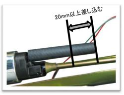
ポンプに付属のインシュレーターと座金を仮組みし、 取り付け位置を確認しパイプに印をつけ、 鉄ノコ等でパイプを切断する。
