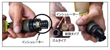
抜き出したポンプに残って いるインシュレーターを 外してください。 ※ゴムインシュレーターは 再使用します。 ※樹脂インシュレーターは 付属のスペーサーと交換を してください。
