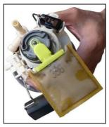
ポンプユニットの底の蓋を外します。 その時、ツメを破損しないように注意してください。 (インシュレーターは再使用します)
