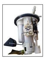
燃料ポンプユニットを燃料タンクより取り出します。 この時、フロートをタンク等に引っ掛けて破損しないようにしてください。
