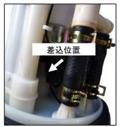
燃料ポンプにカプラーを接続し、燃料ポンプをポンプユニットに差し込みます。 この時、ハーネスが絡まないように注意してください。
