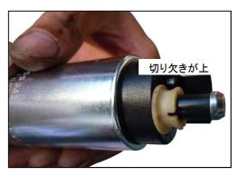
先ほど外した樹脂のインシュレーターを燃料ポンプの 吐出口に取り付けます。 この時、取り付ける向きに注意してください。
