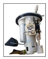
燃料ポンプユニットを燃料タンクより取り出します。 この時、フロートをタンク等に引っ掛けて破損しないようにしてください。
