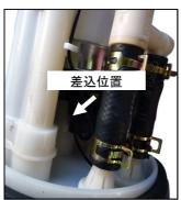
燃料ポンプにカプラーを接続し、燃料ポンプをポンプユニットに差し込みます。 この時、ハーネスが絡まないように注意してください。
