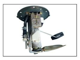
燃料ポンプを燃料タンクから取り出します。 この際、フロートをタンク等に引っ掛けて破損しないように 注意してください。
