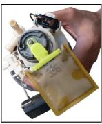
ポンプユニットの底の蓋を外します。 その時、ツメを破損しないように注意してください。 (インシュレーターは再使用します)
