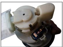
燃料ポンプに最初に外した インシュレーターを取り付け、 ポンプユニットの蓋をはめ込み ます。
