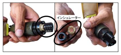
抜き出したポンプに残って いるインシュレーターを 外してください。 (インシュレーターは再使用 します) 燃料ポンプに付属のフィルターを取り付けます。
