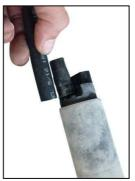
本体のサイズを確認し、付属の燃料ホースを必要な長さにカットします。
