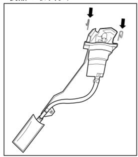
(1)フューエルポンプ本体を純正ブラケットに組み込み、ピンで 固定する。
