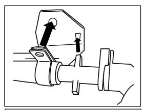
(2)フィルター側ホースアダプターの突起をブラケットに差し込み 付属のM4ボルトと四角ナットでクランプを燃料ポンプブラケットに 固定する。
