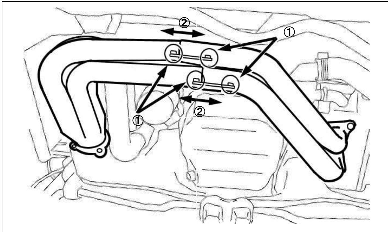
・マニホールド中間差し込み部分のボルト(上図①部分)4カ所ゆるめる
