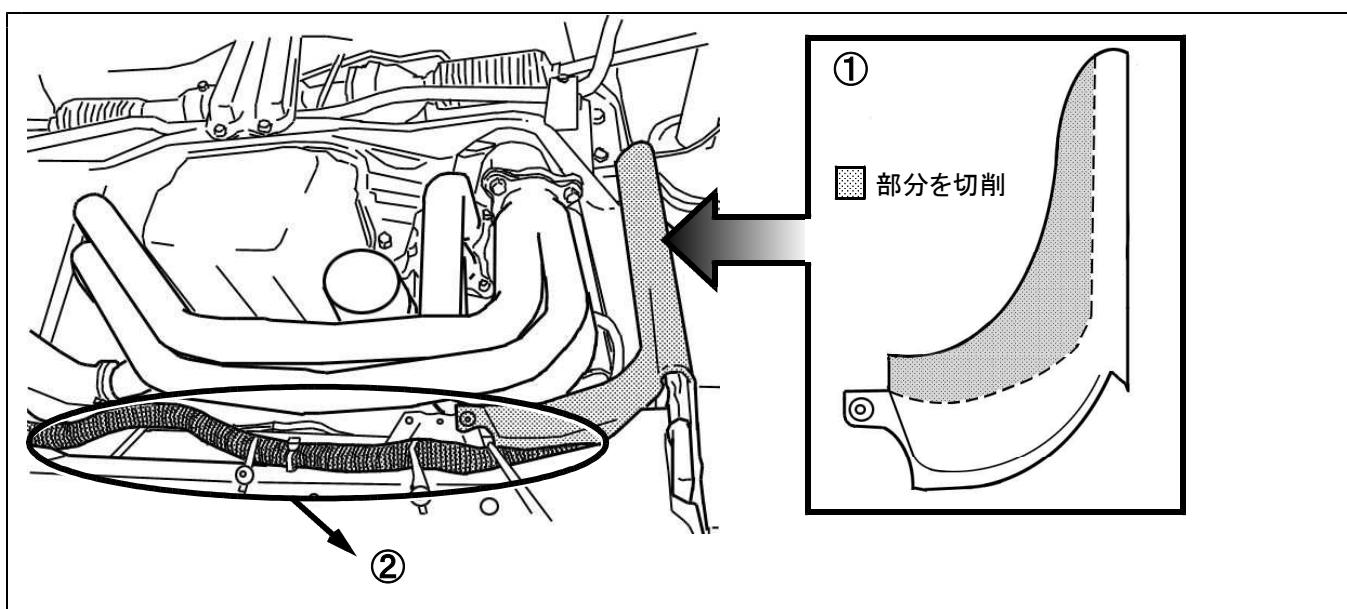
① アンダーカバーを上図のようにマニホールドに干渉しないよう切断する。
