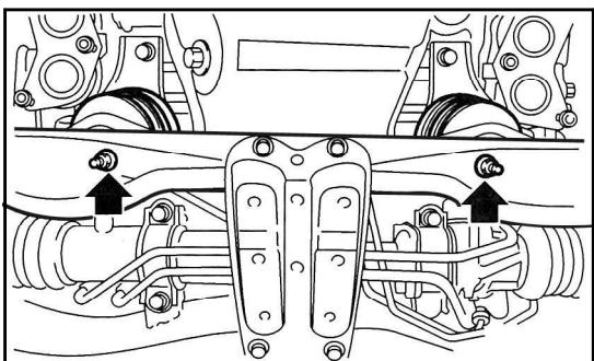
サポートパイプ取り外しの際、サポートパイプとメンバーのクリアランス状態により、車両によってうまく外れない場合があります。
