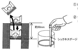
① ピストンを利用して、リングをシリンダーの中間位置まで挿入し シックネスゲージで合口の測定を実施します。
