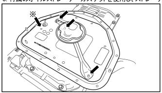
▲ この時、左図※印箇所のボルトも 仮締めしてください。
