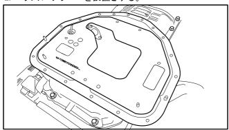
3. 付属のオイルストレーナーガスケットを使用し、ストレーナーを仮締めする。
