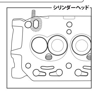
へッド側、ブロック側両面に塗布してください。
