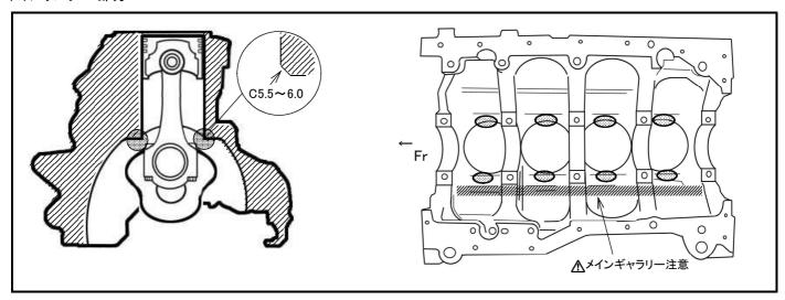
装着の際、シリンダー下部8ヶ所がコンロッドに干渉します。 必ず、各部1mm~1.5mmのクリアランスが確保されるよう 部分をフライスやリューターなどで逃げ加工を実施 してください。
