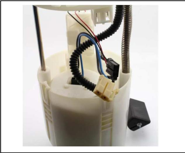
2. 燃料ポンプASSYから燃料レベルセンサーとベンチュリーを取る。
