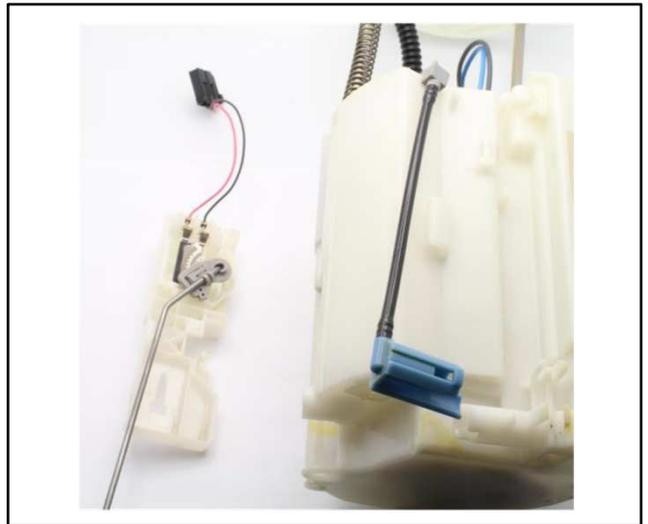
3. 3か所(図 : 緑○)のタブを開きクリップを抜き、燃料ポンプASSYからサブタンクASSYをはずす。
