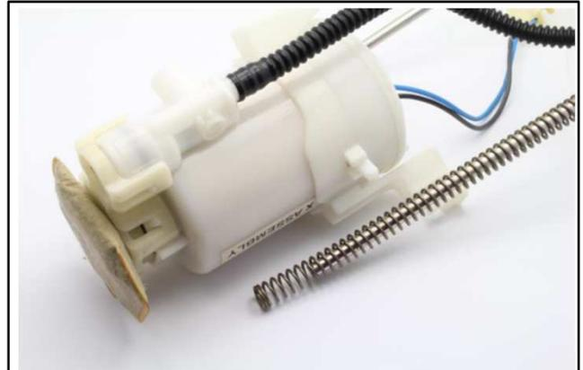
7. センターASSYをサブタンクASSYに戻し燃料レベルセンサーを取り付ける。
