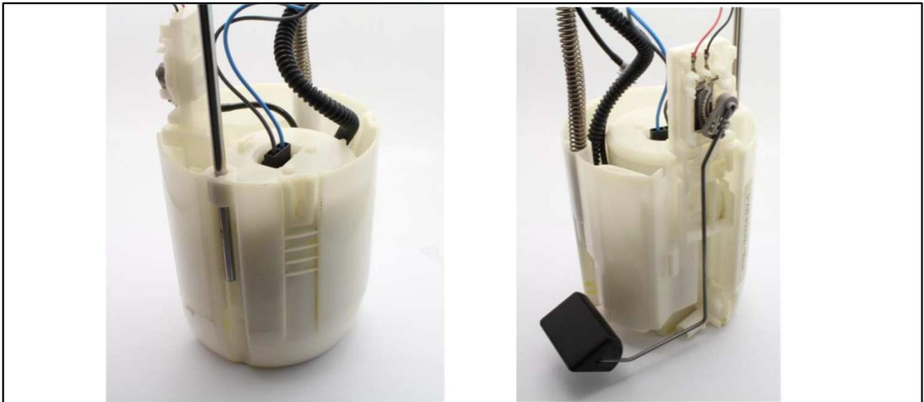
8. ポンプユニットASSYを燃料タンクに組み付ける。この時、燃料ポンプ出口にホースを繋ぎ安全な容器で燃料を受けられるようにする。
