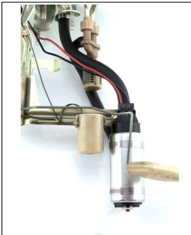
6. ポンプユニットASSYを燃料タンクに組み付ける。
