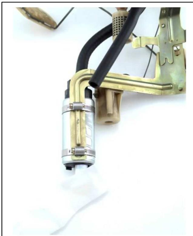
5. センターASSYをサブタンクASSYに戻し、燃料レベルセンサーを取り付ける。
