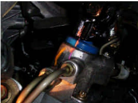
36. ステアリングロアジョイントを合いマークに合わせステアリングギヤASSYに取り付けます。
