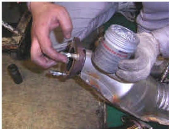
38. 左右触媒コンバーターを組み付けます。
