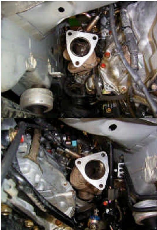
32. エキマニ本体を取り付けナットを仮締めし、O2センサーのカプラーを上から取れるようにしておきます。
