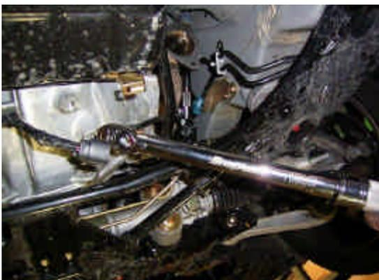
37. 上下ボルトをトルクレンチを使用し締めます。
