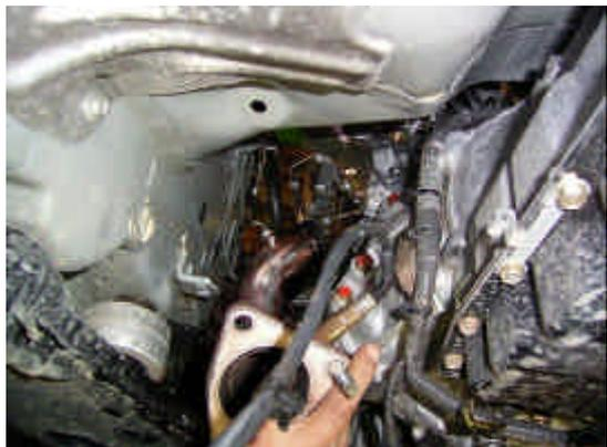
23. 左バンク側は、遮熱板を抜き取り、純正エキマニを外します。
