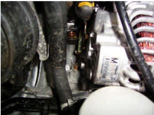
35. 右バンクのハーネスを固定するステーのボルト2本締めます。
