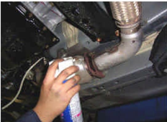
10. 左右触媒コンバーターを外します。
