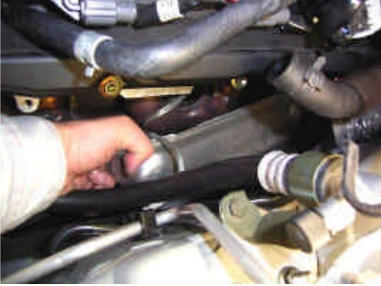
21. 左右エキマニ遮熱板のボルトを外しておきます。
