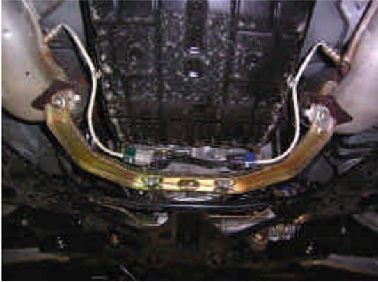
8. 左右触媒コンバーター、トランスミッション間のブラケットを外す。
