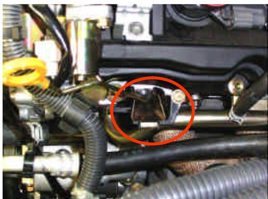
41. レベルゲージを浮かして、レベルゲージガイドを取り付けます。
