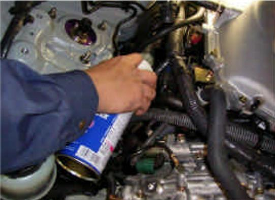
22. 純正エキマニのナット部分に潤滑剤を塗布し、左右各 6本外します。
