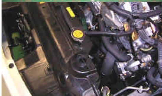
12. ラジエターキャップを外し、クーラントを抜きます。
