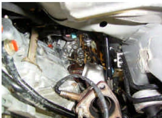
24. 右バンクは、ステアリングシャフトを避けながら、エキマニをずらし遮熱板を抜き取り、純正エキマニを外します。
