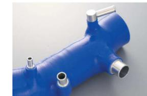
ホースニップルに、つば付きタイプを採用し脱着時の作業性を向上しました。また、インテークマニホールドを取り外さず装着できるため作業時間も大幅に短縮でき、この製品の大きな効果を手軽に体感していただけます。
