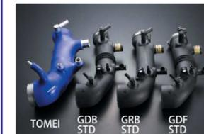
抵抗となる蛇腹を廃止し、曲げR部分も極力なめらかに設計し、さらに全体を大容量化した。また、ホース全体に補強を施すことにより、高ブースト時にもつぶれることなく、大量かつ安定した吸入空気をターボチャージャーに供給します。
