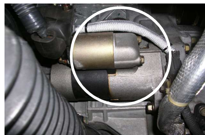
車体左側のスターター配線
