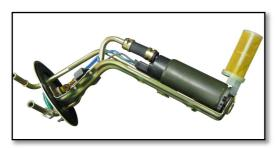
燃料ポンプを燃料タンクから取り出す。 この際、フロートをタンク等に引っ掛けて破損しないように 注意する。
