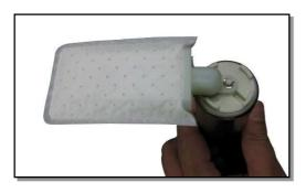
ポンプ本体に付属のフィルターを付属クリップを使い取り付け装着する。
