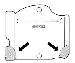
カムバッフルプレートの左図2カ所を平らになるよう削り落としてください。
