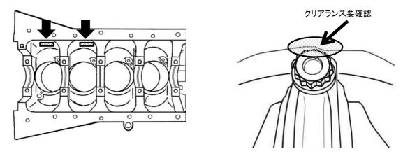
シリンダーブロック、オイルパンの合わせ面より50~60mmの範囲でコンロッドと干渉する場合があります。 1~1.5mmのクリアランスが確保できない場合は、フライスやリューター等で逃げ加工を実施してください。
