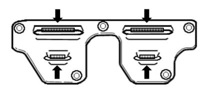
コンロッドの逃げ加工として、 1mm~1.5mmのクリアランスを 確保するよう、左図4カ所の ヤスリ加工を 実施してください。
