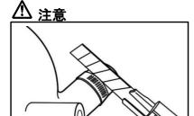
ターボサクションホース装着によりブローオフバルブがタワーバーと干渉する場合には、サクションホースのブローオフバルブ取付部分にホースバンドを取り付けた状態をガイドとし、カッターなどで切断して調節してください。
