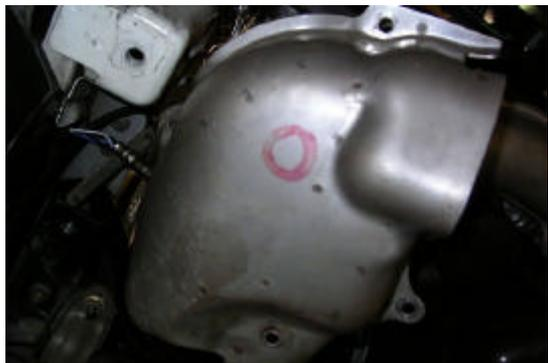
15. サポートパイプ、エキマニ連結部の遮熱板をずらし、連結部のナットを外します。
