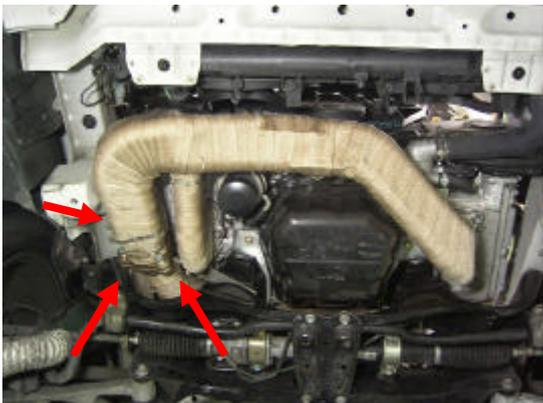
35. エキマニとサポートパイプの間に付属のガスケットを挟み、仮締めします。
