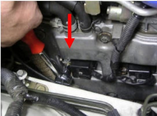
45. エキマニ側O2センサーハーネスのステーをダイレクトイグニッションのボルトと共締めします。
