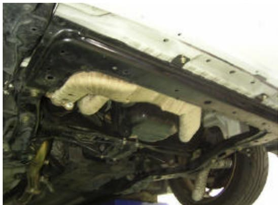
49. エンジンを始動し、排気漏れが無いことを確認し、サブフレームを仮組みします。
