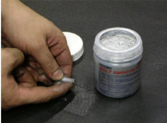
20. ネジ部にTOMEボルトスムースペースト等を塗布してから、サポートパイプのタービン側フランジに、スタッドボルトを取り付けます。
