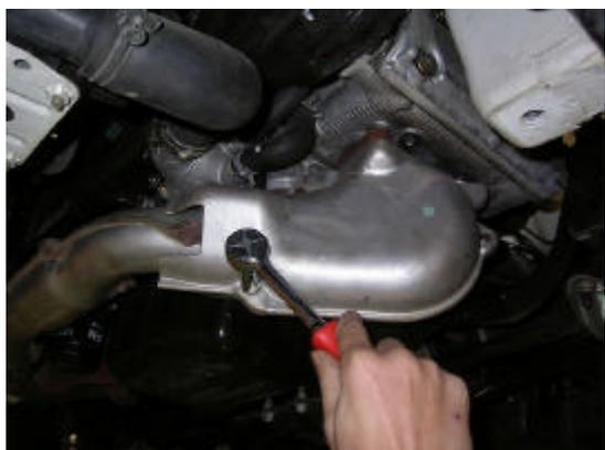
16. エキマニのフランジ側の遮熱板を外し、ヘッド側のナットを外し、純正エキマニを外します。
