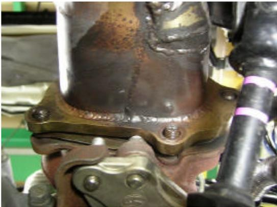
41. タービン側スタットボルトにTOME ボルトスムースペースト等を塗布し、フロントパイプを組み付けます。
