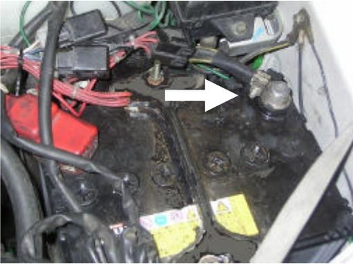
2. 先にターバーを外し、矢印のブローオフのボルト2本とホースを外しておきます。
