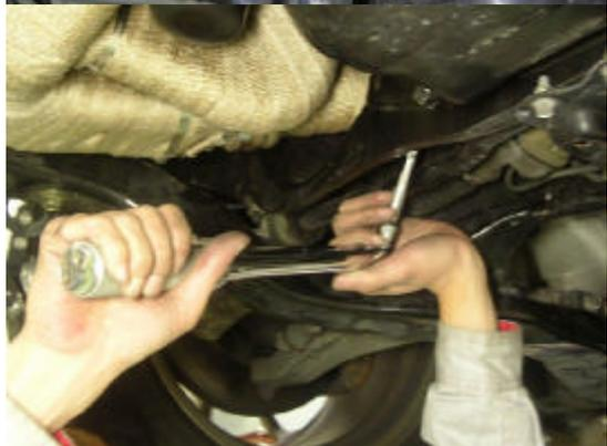
39. フロントパイプを取り付ける前に、遮熱板の位置関係を、再度、確認しておきます。
