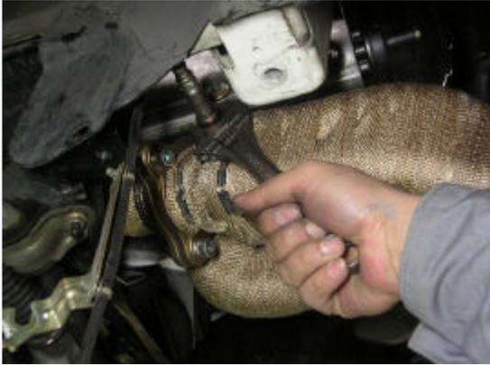
40. O2センサーネジ部にTOME ボルトスムースペースト等を塗布し、エキマニにO2センサーを取り付けます。
