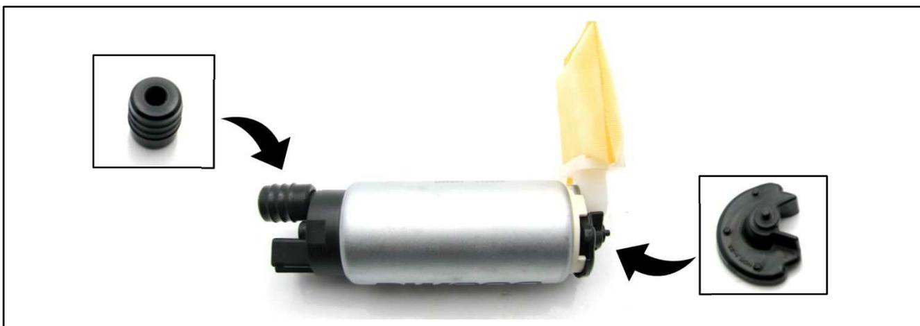
5. フューエルポンプをASSYの所定位置に取り付けをしてからカプラーを接続し、ポンプブラケットを所定の位置で固定する。
