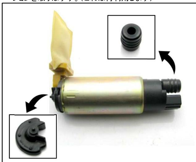
4. 付属のフィルターをフューエルポンプに取り付けクリップで固定し、純正ポンプから取りはずしたグロメットとラバークッションを取り付ける。
